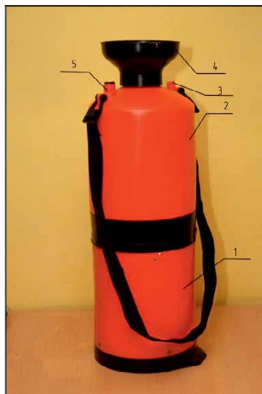
Рис. 1. Устройство для получения электрохимического гипохлорита натрия
